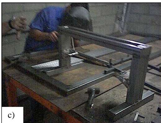
Figura 7: Mecanismo para ensayo de flexión a) fresando b) Mecanismo final c) Soldando d) Diseño
